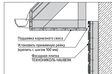
Рис. 9.1. Монтаж верхнего ряда под карнизным свесом
